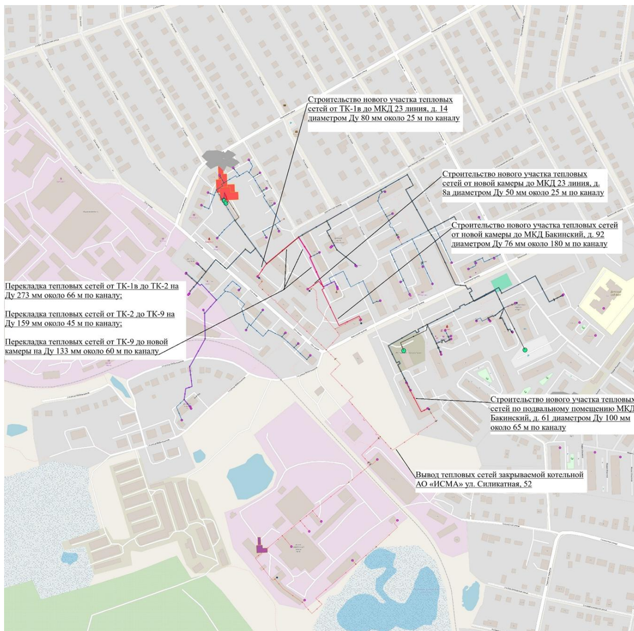
Рис. 3.4. Схема места расположения предлагаемого строительства участка тепловой сети для переключения потребителей закрываемой котельной АО «ИСМА» на котельную ООО «Система Альфа».
